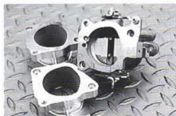
●スロットルはAE111の4A-G用。スロットルは精度が重要なので純正品を使うのが一番かも。価格も抑えられるし。
