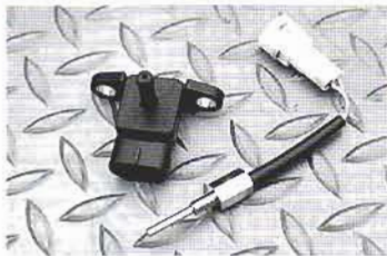
●エアフロから圧力センサーへ変更するので、新たにセンサーを取り付ける。写真左が圧力センサーで右が吸気温度センサー。
