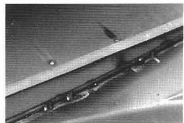
▲プリスターフェンダーの膨らみは鉄の棒を曲げて作る。あまり細いものだと膨らませ切れないし、太いと曲げるのが大変。
