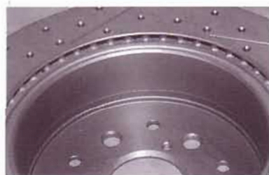
▲フロントの車速信号を取るために、ローターの内側にピックアップセンサーを付ける予定。読み取り用のギヤも製作して仕込む。
