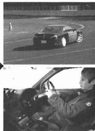
■立ち上がりは2速のときと同じ。クラッチをゆっくりと、回転を合わせながらつなげたらできたも同然だ。ついでにアクセルを踏み、ステアリングを戻しながら立ち上がるんだ。ここで大切なのは「カウンターを戻しながら」ということ。当てたままだとドリフトが止まってしまうし、内側に巻き込んでしまう。ステアリングワークでクルマの位置を調整しよう。
