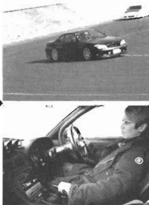
■ココが一番大切なところ。2速にシフトダウンするんだけど、当然リヤが流れた状態で操作しなければならない。スピードが落ちすぎてからギヤを変えると、ドリフトが止まってしまうからね。基本的にはグリップのときと同じ位置、つまりクリップ手前でシフトダウンする。少し早いタイミングでクラッチを踏み、落ち着いて回転をシッカリ合わせてつなげよう。
