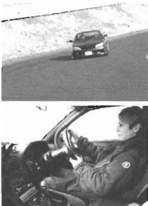
■最初はスピードに目が追いつかず怖いと思うので、慣れるまでは進入時に軽くブレーキを踏んでスピードを調整してもOK。そしてクラッチを蹴るタイミングだが、フェイントをかけるようにステアリングを内側に切り込んで、外側に荷重をかけた状態で蹴ること！ そうすればカウンターにリヤが流れてくれるんだ。仮に直進状態で蹴ったとしても、な~んにも起きないぞ。
