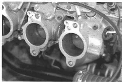
▲今は4スロがむき出しのままだけど、ここはインタクションボックスが付く予定。その前にファンネル仕様も試してみる。
