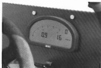
▲インパネはN2風の作り。材質はカーボン。これは坂東商会オリジナル。メーターはモータックのタッシュロガーを使っている。
