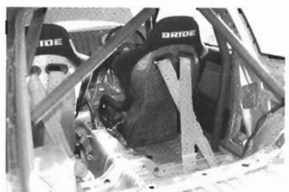
▲シートはブリックのカーボン。ベルトはタカタ製。ボディもフルスポット増しになって、車体は本気仕様です。
