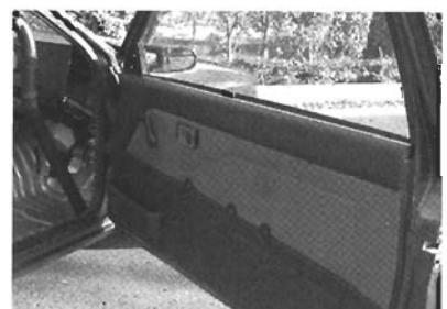
▲ドアはFRP製でウインドはホリカーボネートなので超軽量。フロントウインドもGTマシンに使っているのと同じ材質だ。
