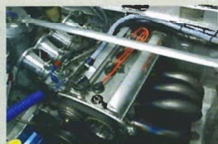
●ウエタケエンジニアリングのエンジンベンチで、暫定セッティングながら210馬力を超えたエンジン。燃調は若干変更している。
