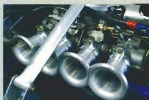
●本当はサージタンクを装着したいところだけど、ブレーキマスターとの干渉など問題が残っているので、今回はファンネル仕様で。
